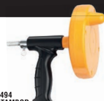
9716494 AMB TAMBOR. Per a desguassos domèstics petits o mitjans. Filferro d'acer de ressort resistent a l'oxidació, vareta equipada amb punta en espiral. Recipient de plàstic autoemmagatzematge amb mànc giratori. Empunyadura de pistola ergonòmica per a més comoditat. Coberta del tambor de plàstic. 6 m x 9 mm.
